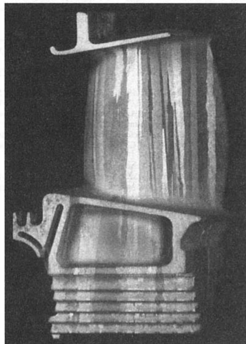
Fig. 32 Typhoon cooled HP turbine blade DS CM 186 LC alloy
